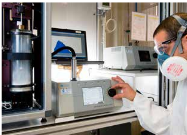
LNE : Plateforme MONA pour la métrologie des aérosols : caractérisation des nanopoudres en taille et en nombre.
